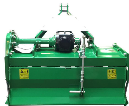
Justerbar bagskærm hvor man via fjeder, kan bestemme bagpladens tryk (planering)
