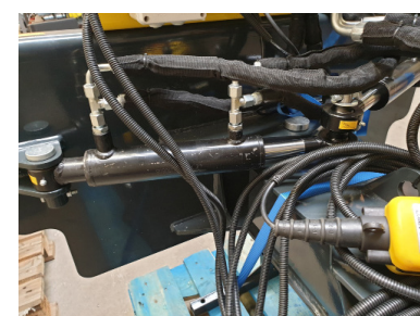
Stempel som påvirkes af controlleren (højre/venstre sving)
