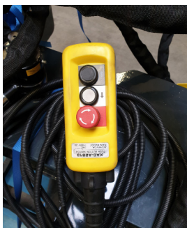
Controller til højre/venstre sving af fræsehoved.
