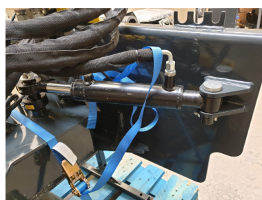
Stempel som påvirkes af controlleren (højre/venstre sving)
